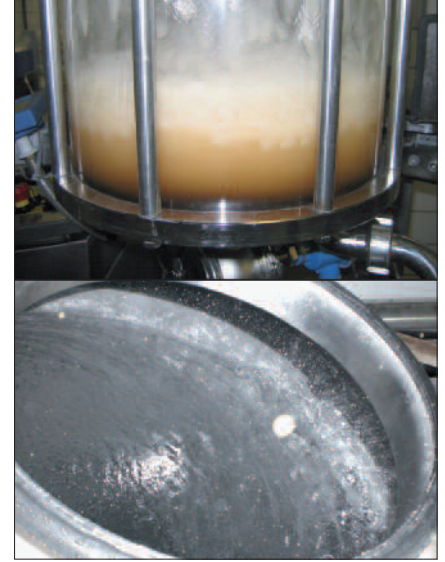
Abbildung 8: Schaumentwicklung durch Ringspaltdüse mit schlecht eingestellter Produkteinbringung und senkrechtes Auftreffen des Fallfilmes auf den Füllstand
