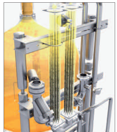
Abbildung 9: Vollständige Aroma- und Wasserdampfkondensation der verdunsteten Dämpfe
