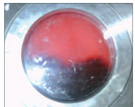
Abbildung 5: Scharfe Schaumgrenze bei einer stark zum Schäumen neigenden Erdbeersaftproduktion
