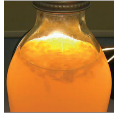
Abbildung 3: Aufgeschwommene Orangenzellen in der Flasche durch ungenügende Produktentgasung
